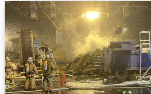
リチウムイオン電池が家庭ごみに混入して出される ことで、収集車や処理施設での 火災 が多発！
