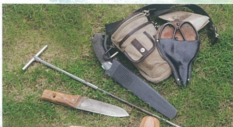
中央T字の金属棒は、「鋼棒（こうぼう）」といい、地中の根や幹に刺して腐植の状態を調べるために使います。
