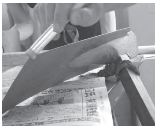
写真1 ブラシで鉄の錆を落としているところ
