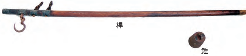
桿の長さ181.7cm(約6尺)、樫製。錘には本来、錘糸があり、桿に掛けて計量した。
