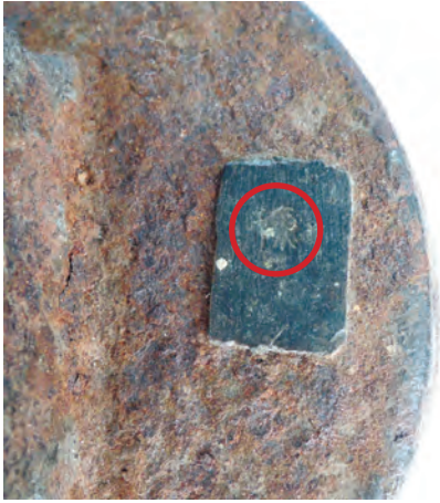
錘の頂部 ○のなかに「検」と刻印がある。 「新器検」と呼ばれる検印で、1876(明治9)年〜1892(明治25)年の期間に押されていた。
