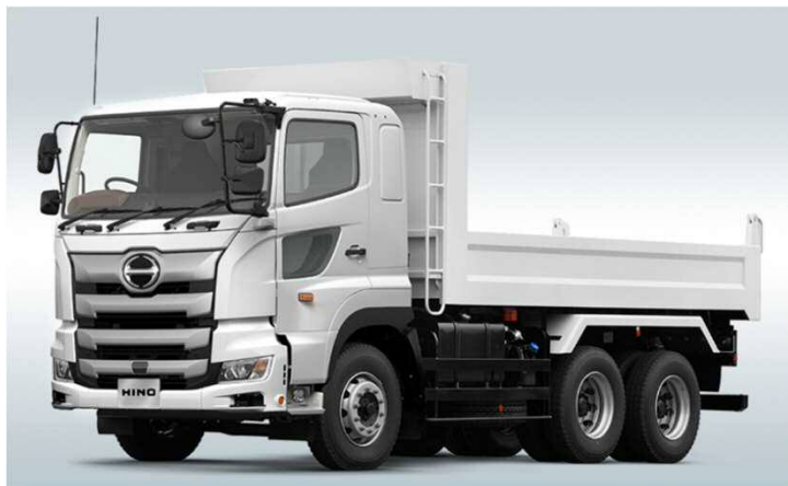
一番多い工事車両 10tダンプ
