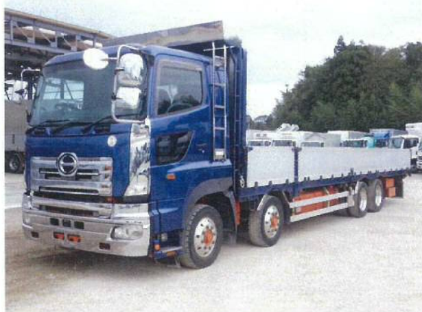
資材機材運搬車両 平ボディ 6~10t車
