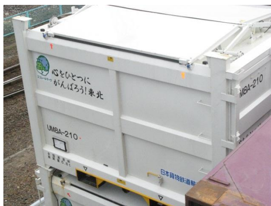
③ 震災廃棄物コンテナ
