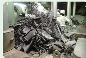
焼却炉から出た燃やさない不燃物
