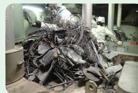
焼却炉から出た不燃物
