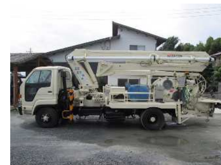
コンクリート圧送車両 ポンプ車 210t車
